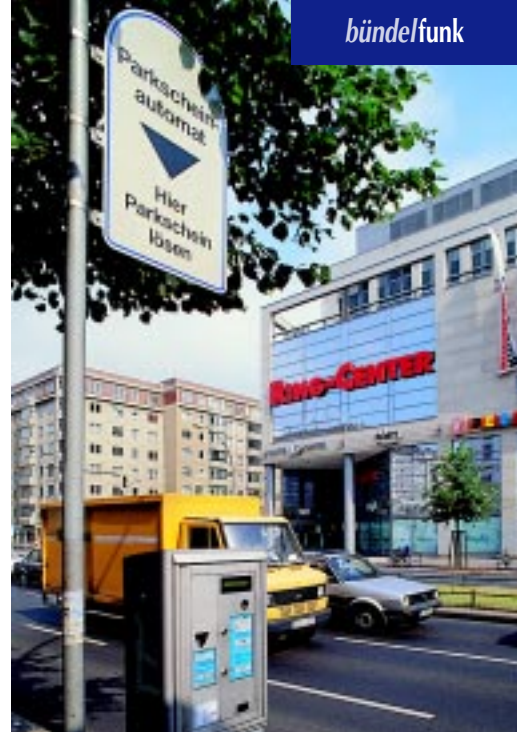
Hier funkt der Automat: Neben den ■ Parkscheinautomaten werden auch die 16 Anzeigetafeln des dynamischen Ver- kehrslitsystems via Bündelfunk gesteuert.
